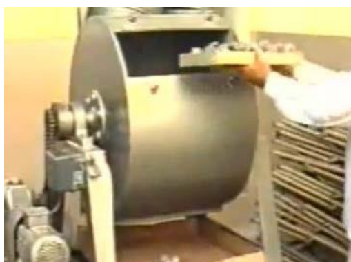
Figura 218 - 4. Colocación de la muestra dentro de la máquina de Los Ángeles
